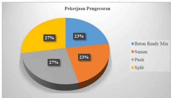
Gambar 7. Diagram Persentase Sisa Material Pekerjaan Pengecoran
