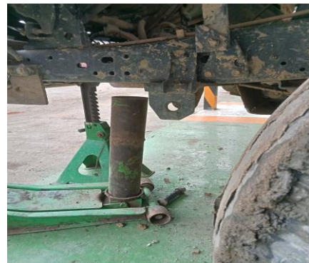
Gambar 3. Alat bantu sebelumnya menggunakan pipa tipis
