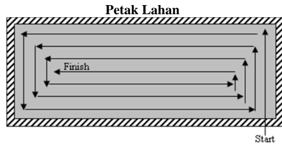
Gambar 5. Ilustrasi arah gerak kerja pemotongan mesin panen pada lahan
