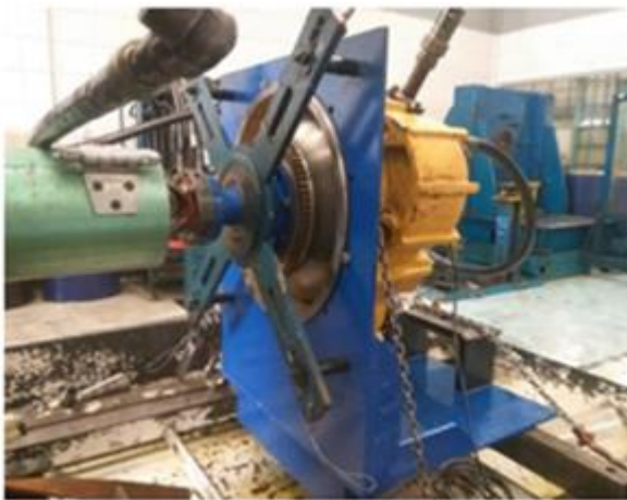
Gambar 5. Uji coba alat bantu pengujian Torque Converter
