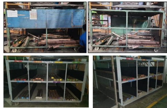
Gambar 8. Rak penempatan frame sebelum dan sesudah perbaikan.
