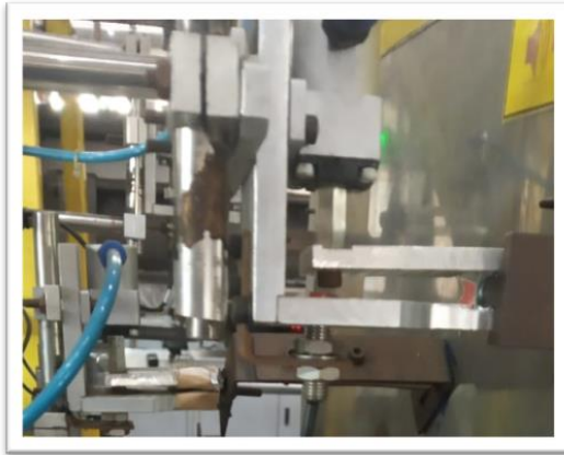
Gambar 7. Pengujian pengambilan insert collar dari jig collar
