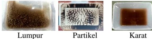
Gambar 5. Kotoran dalam saluran cooling mold
