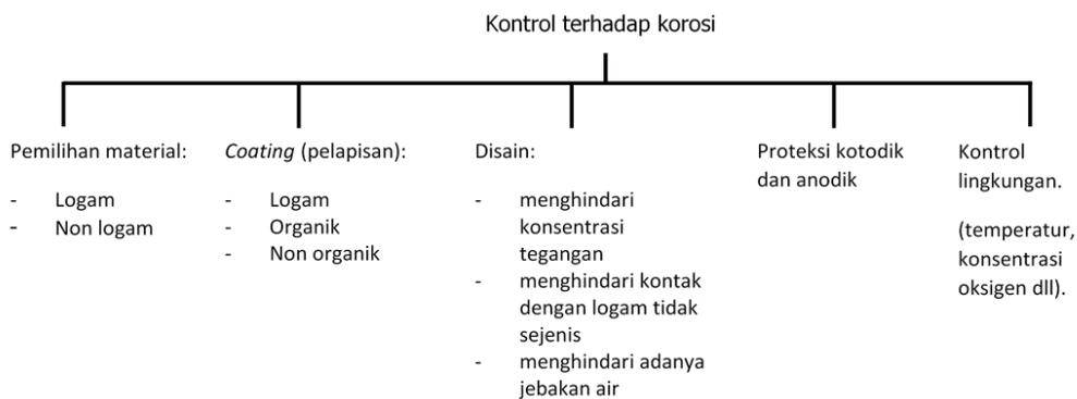
Gambar 6.8 Ilustrasi control laju korosi
