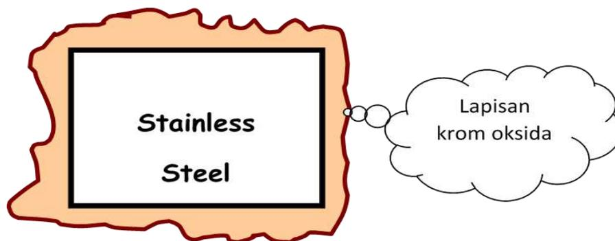
Gambar 4.6 Ilustrasi Mekanisme perlindungan korosi dari baja tahan karat.
