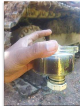
Gambar 5. Fuel pada pre-filter sangat kotor dan keruh
