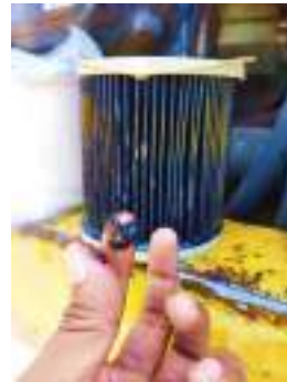
Gambar 4. Cairan hitam kental di element water separator
