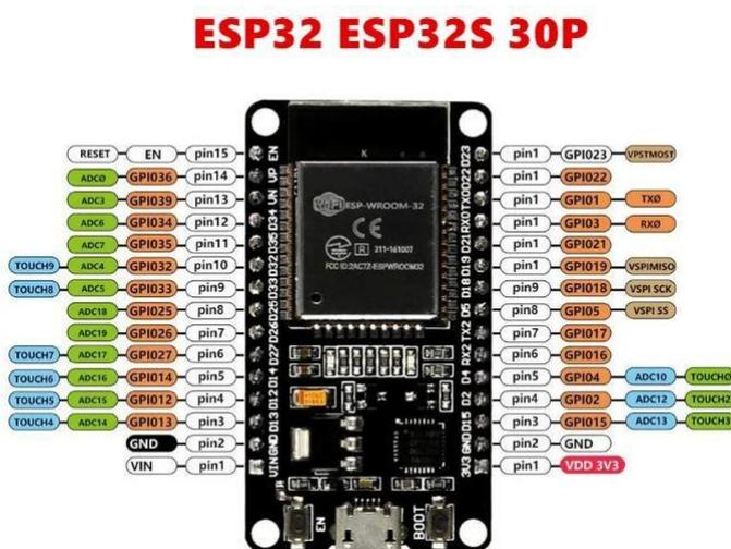
Gambar 2. Pinout Mikrokontroler ESP32
