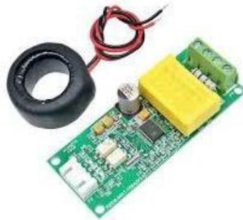
Gambar 3. Sensor Arus dan Tegangan PZEM-004T
