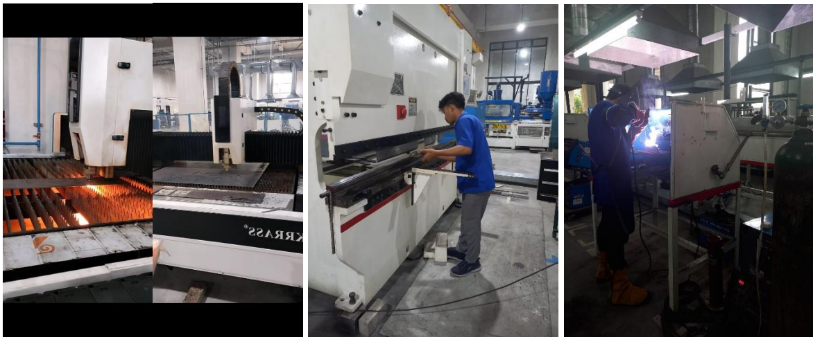
Gambar 9. Proses fabrikasi frame otoped listrik
