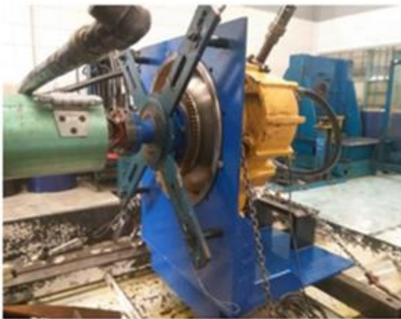
Gambar 5. Uji coba alat bantu pengujian Torque Converter
