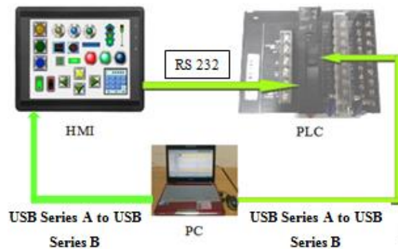
Gambar 4.6 Komunnikasi PLC CJ2M CPU11 – HMI NS8-TV00B-ECV2
