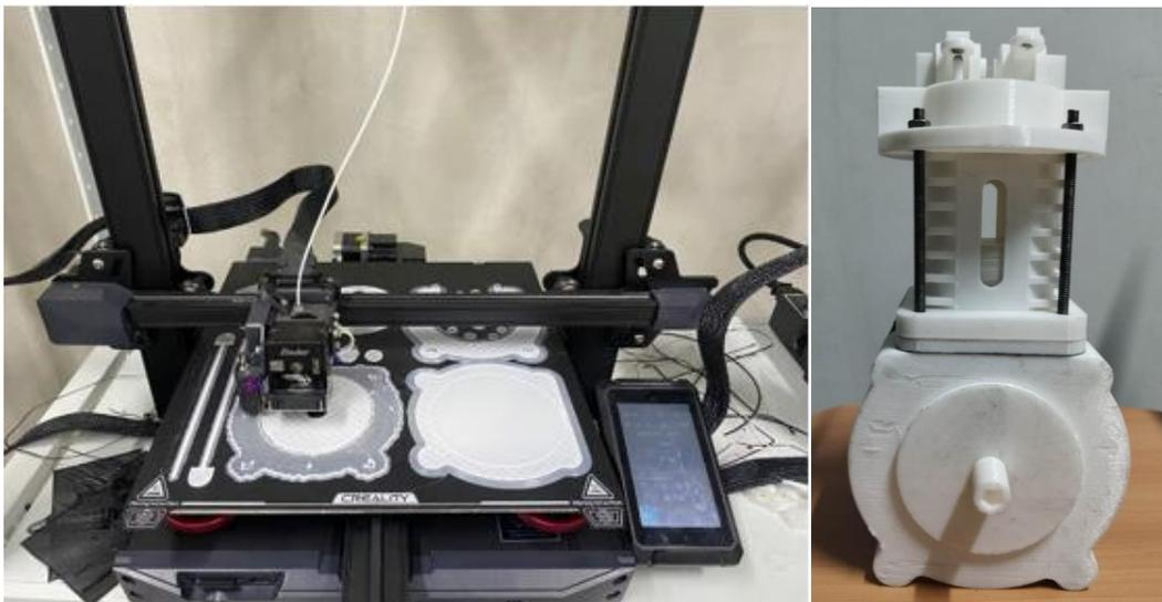
(a) Proses pembuatan dengan 3D *printing*
