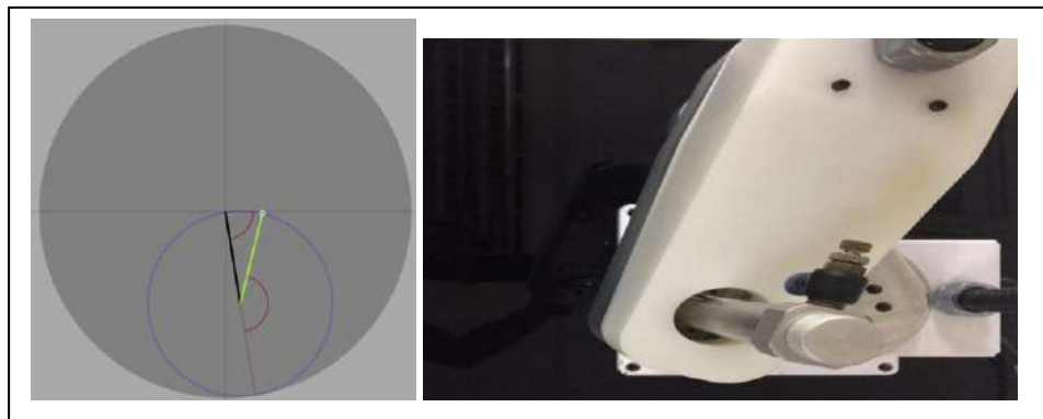
Gambar 4.6. Simulasi dengan sudut gerak robot manipulator ( \theta_1 -64.390. \theta_2 . 131.575.)
