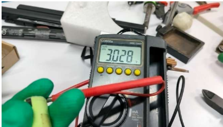
Gambar 9 Pengukuran Voltase Baterai
