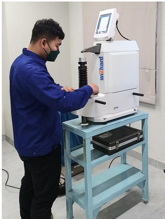
Gambar 8. Pengujian Homogenitas Material
