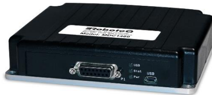
Gambar 3.20 Roboteq MDC1460 Kontroler Khusus AGV
