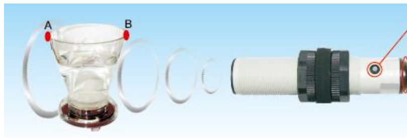
Gambar 2.24 Cara Kerja Sensor Ultrasonik
