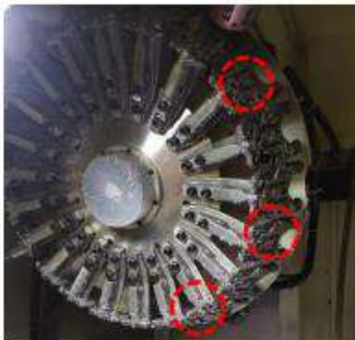
Gambar 3. Tumpukan Scrap pada Tool Magazine
