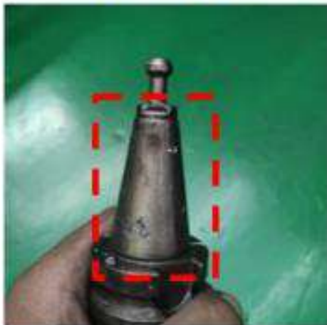
Gambar 4. Scrap yang menempel pada Arbor
